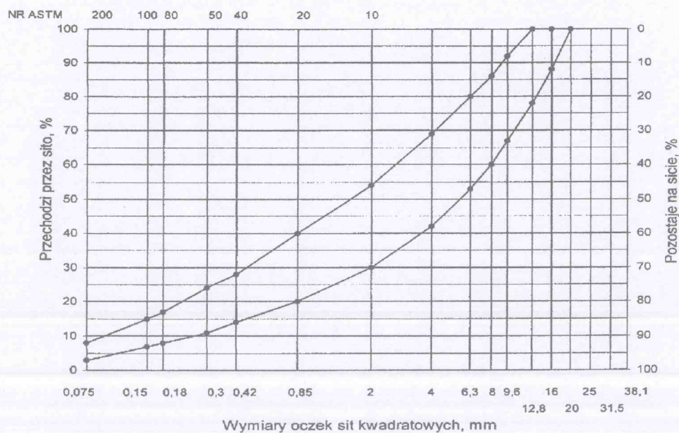
Rys. 9. Krzywe graniczne uziarnienia mieszanki mineralnej BA od 0 do 16 mm do warstwy wiążącej, wyrównawczej i wzmacniającej nawierzchni drogi o obciążeniu ruchem KR1 lub KR2
